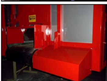
Dubbele hydrau-elektrische aandrijving, rechtstreeks op de aandrijftrommel gemonteerd (zonder ketting), onderhouds vrij, variabele riemsnelheid, mogelijkheid om elektrisch te lossen door aansluiting op het voedingsnet ofwel zonder elektriciteit d.m.v. de hydrau-pomp op de trekker
