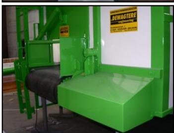
Elektrische aandrijving, rechtstreeks op de aandrijftrommel gemonteerd (zonder ketting), onderhouds vrij, variabele snelheid m.b.v. frequentieregelaar
