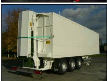
Onderlosser met aangebouwde opvoerzwenkband, om op hoogte te lossen
