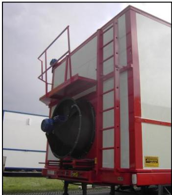
Ventilator geïntegreerd in voorwand voor het drogen van o.a. ajuinen
