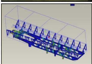
Ontwerp en gewichtsoptimalisatie m.b.v. eindige elementen software (materiaalspanning- en doorbuigingsberekening)
